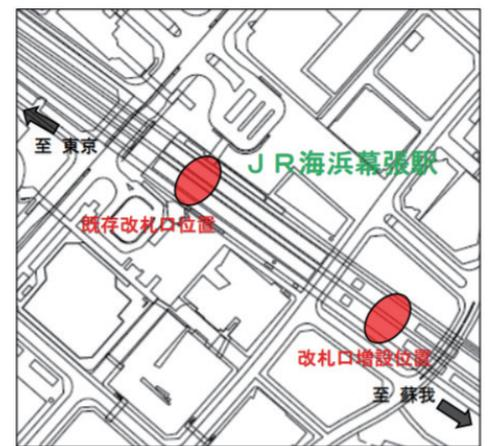
新改札口が予定される位置を示したプレスリリースの図。東京側のホーム先端が蘇我側に移動し、蘇我側の先端は現在の位置よりも70mほど伸びている。赤丸で示された改札口予定位置は南口ではユニデン駐車場前になり、北口ではアウトレットパーク第4駐車場の位置になる。
